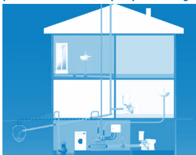
Figura 1: Esempio di installazione con pompa sommergibile:
